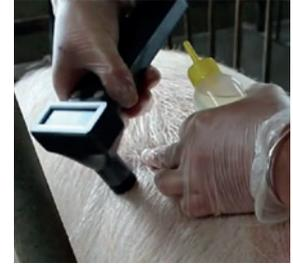
4) Posez l'appareil sans appuyer fort. Validez la mesure quand 2 diodes sont allumées
