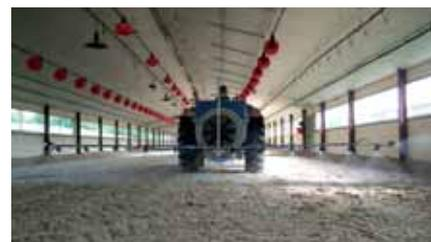
interchangeables suivant le produit utilisé. Une rampe de pulvérisation modulable de 4, 6 ou 8 m de large permet l'application de produits au sol (insecticide, soude liquide). Il permet de localiser ainsi les applications de chaque produit, grâce au système de fermeture de buses de façon indépendante...
