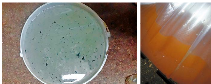
Photos 3-4 : Eaux récupérées au niveau des purges dans les canalisations d'eau de post-sevrage (Source : Porc.Spective)
